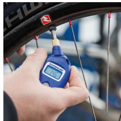
Contrôle de pression avec l'Airmax Pro.
