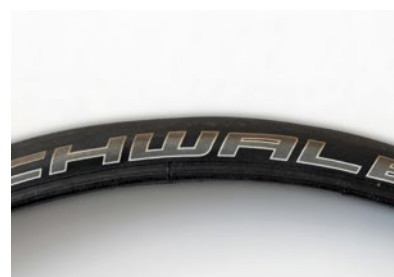
Exemple de marquage altéré
