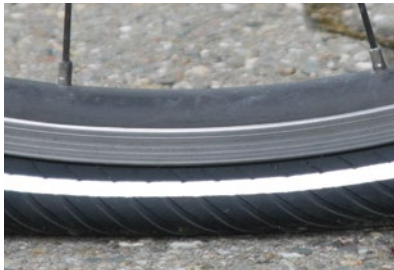
Pression insuffisante. Ici, la pression est bien trop faible.
