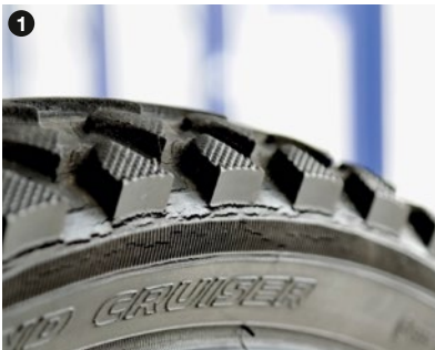
Fissures de fatigue
