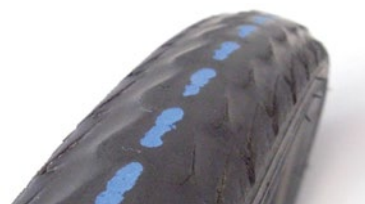
Le renfort anti-crevaison apparaît. Le pneu doit être remplacé d'urgence.
