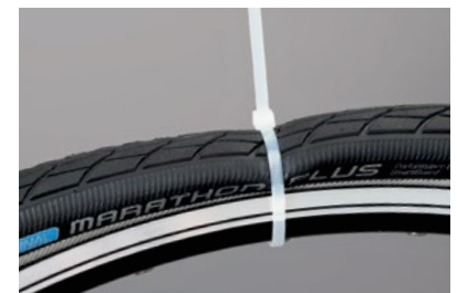
Een kabelbinder als helpende derde hand.
